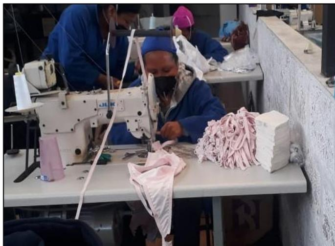
*Figura 25: Colocación del elástico y la tira*
