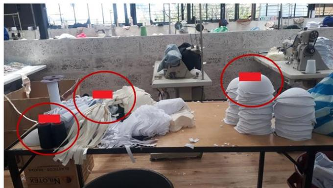
Figura 48: Materiales en desorden, colocación de tarjetas rojas
