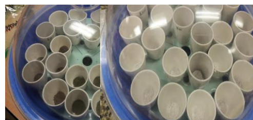
Figura 28. Pesaje y calcinación de las muestras de tipo después de 24 horas para determinar metales
