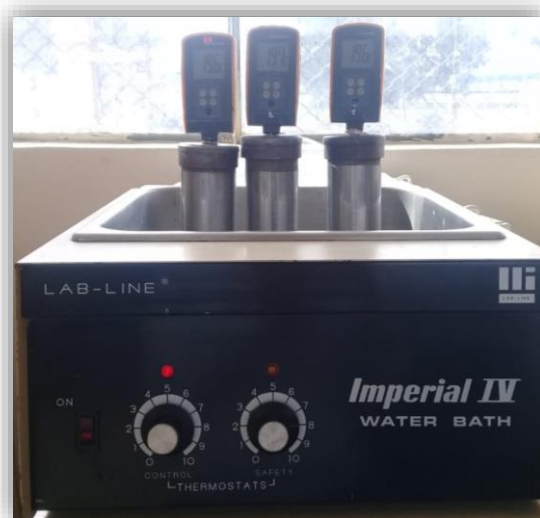
Fotografía 6. Determinación de difusividad térmica
