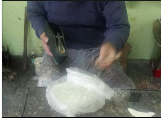
Figura N° 28: Adición de adherente en la planta del corte
