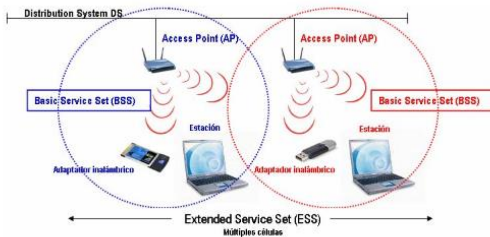
Figura N° 4. Arquitectura funcional del estándar IEEE 802.11. [20]
