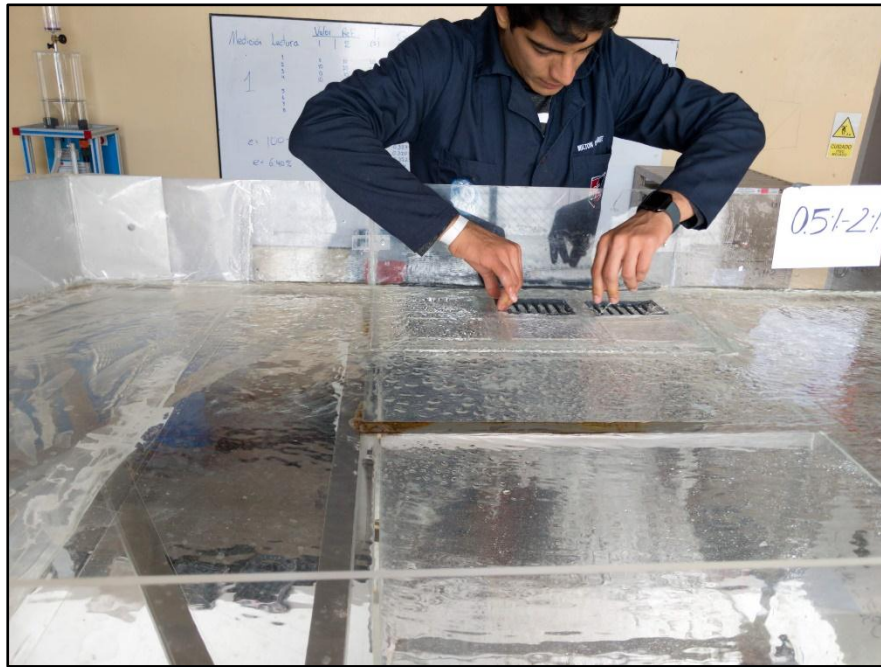
Fotografía 13.- Pendiente Longitudinal 0.5% - Pendiente Transversal 2%
