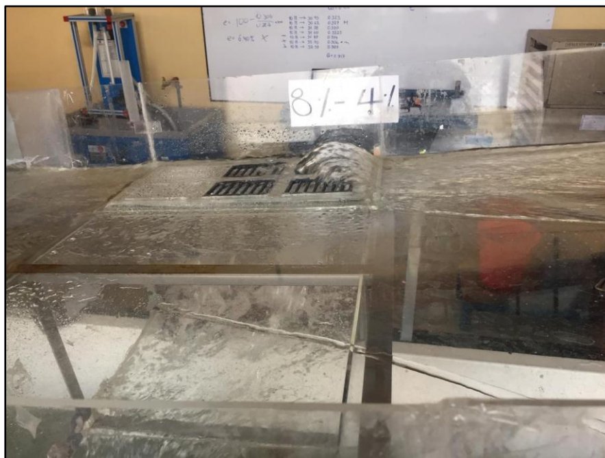
Fotografía 18.- Pendiente Longitudinal 8% - Pendiente Transversal 4%
