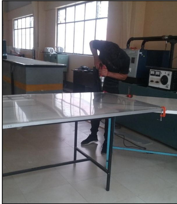
Fotografía 1.- Ensamblaje de la estructura metálica para la base de acrílico.
