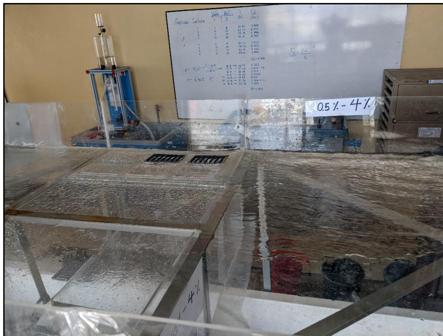
Fotografía 14.- Pendiente Longitudinal 0.5% - Pendiente Transversal 4%
