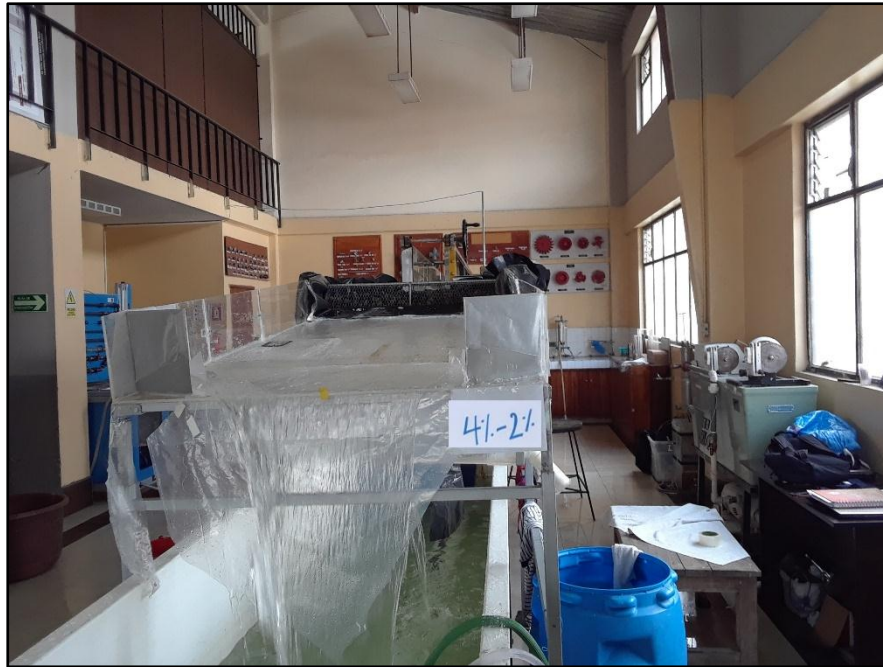
Fotografía 7.- Pendiente Longitudinal 4% - Pendiente Transversal 2%
