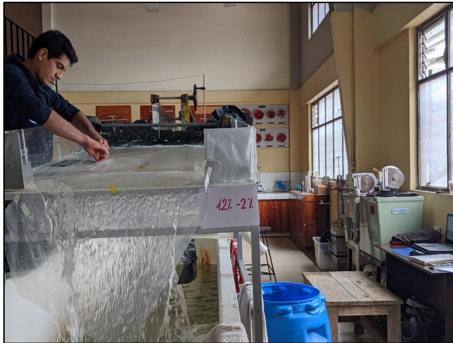
Fotografía 11.- Pendiente Longitudinal 12% - Pendiente Transversal 2%
