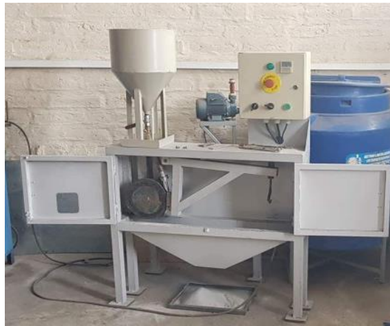
Figura 2.18 Ensayo de desgaste Abrasivo
