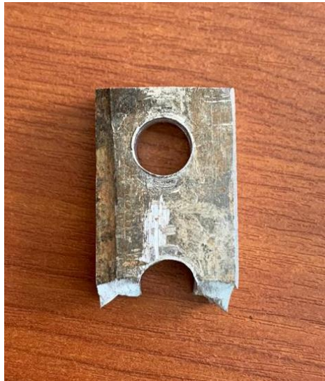
Figura 8. Probeta de Aluminio - Ensayo de rotura Fuente: Autor
