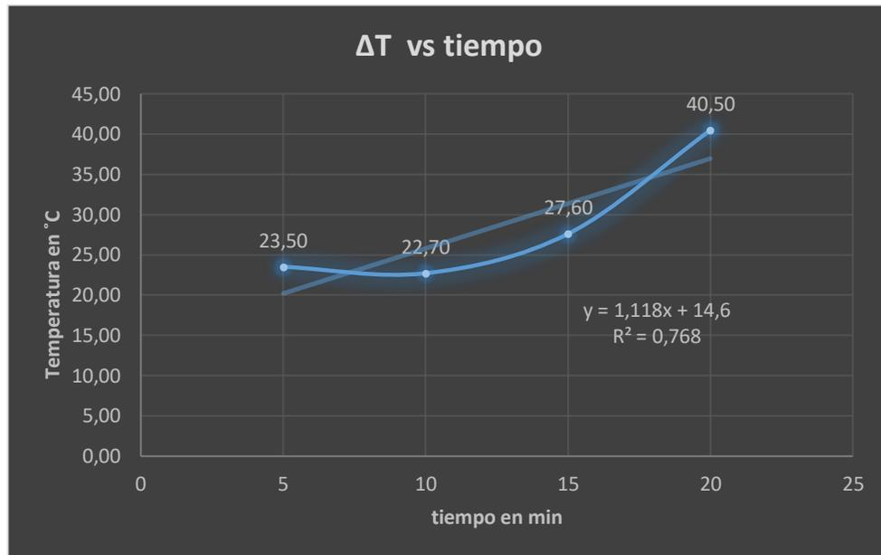
**Figura 3-4:** Curva de la  $\Delta T$  con respecto al tiempo con 6 Tubos de calor
