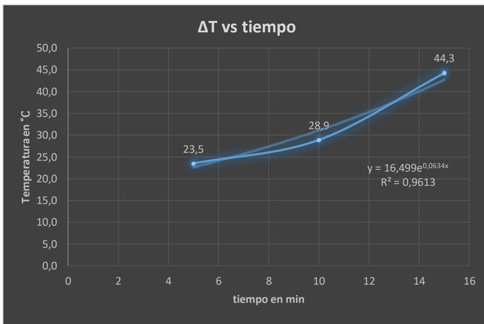
**Figura 3-8:** Curva de la  $\Delta T$  con respecto al tiempo con 3 Tubos de Calor
