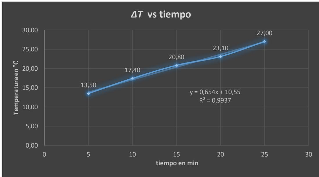
**Figura 3-16:** Curva de la temperatura promedio con respecto al tiempo con 6 Tubos de calor en el Calderín.
