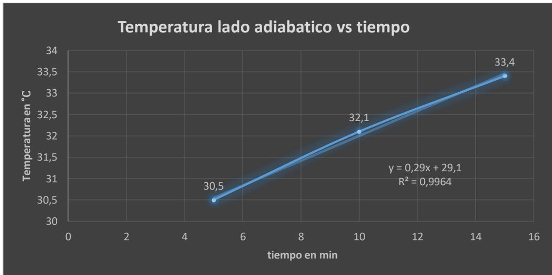
**Figura 3-7:** Curva de la temperatura lado adiabático con respecto al tiempo con 3 Tubos de Calor
