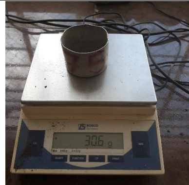
Tomar muestra superior e inferior pesar y dejar secar 24 horas para pesar
