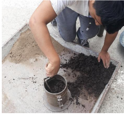
Colocar en el molde hasta 1/3 del molde
