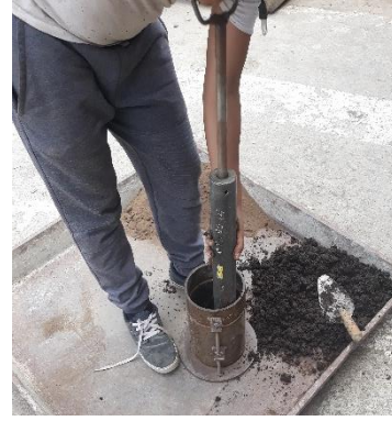
Compactar con el martillo
