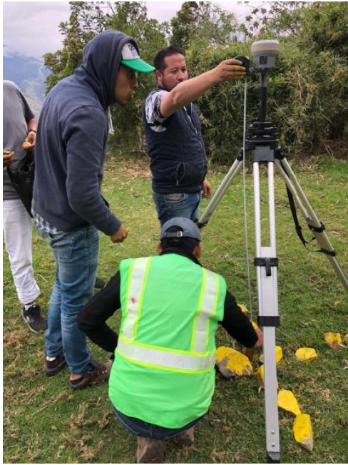
Tomar la altura de referencia desde el clavo hasta el R10 (base)
