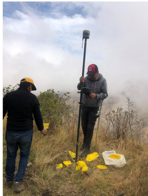
Toma de puntos georreferenciados con el móvil del R10
