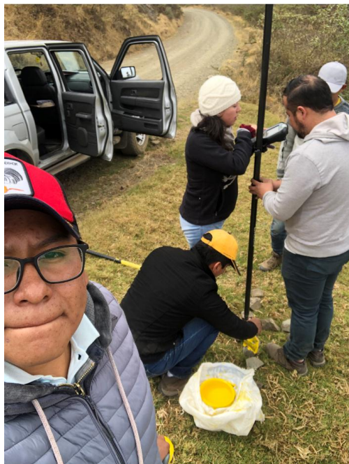
Sincronización de la base del R10 con el móvil
