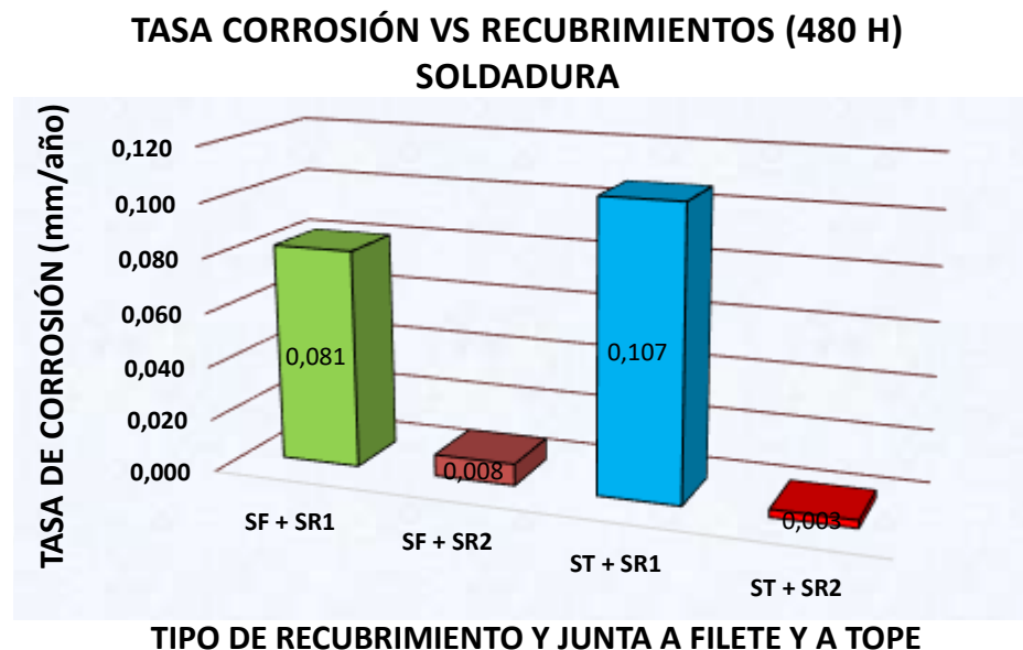
Fig 4.18: Comportamiento de la corrosión del Acero ASTM A -500 Galvanizado vs los diferentes sistemas de recubrimientos con juntas a filete y tope para 480 horas.
