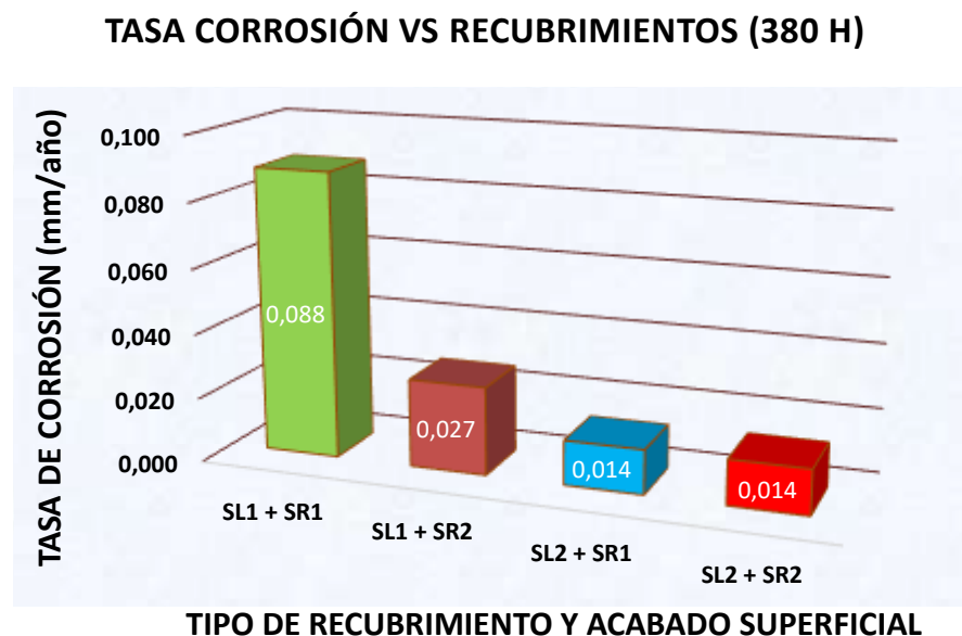
Fig 4.7: Comportamiento de la corrosión del Acero HSLA 1011 Gr – 50 vs los diferentes sistemas de limpieza y recubrimientos aplicados para 380 horas.
