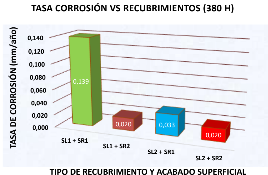
Fig 4.8: Comportamiento de la corrosión del Acero ASTM A - 500 vs los diferentes sistemas de limpieza y recubrimientos aplicados para 380 horas.
