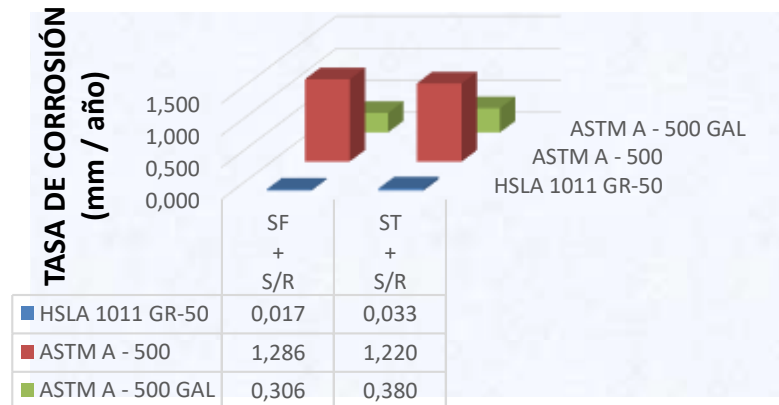
Fig 4.44: Tasa de corrosión de los materiales HSLA – ASTM A – 500 y Galvanizado sin ningún tipo de recubrimiento con juntas a filete y tope, para 280 horas.
