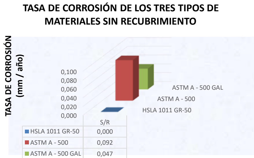
Fig 4.26: Tasa de corrosión de los materiales HSLA – ASTM A – 500 y Galvanizado sin ningún tipo de recubrimiento para 480 horas.
