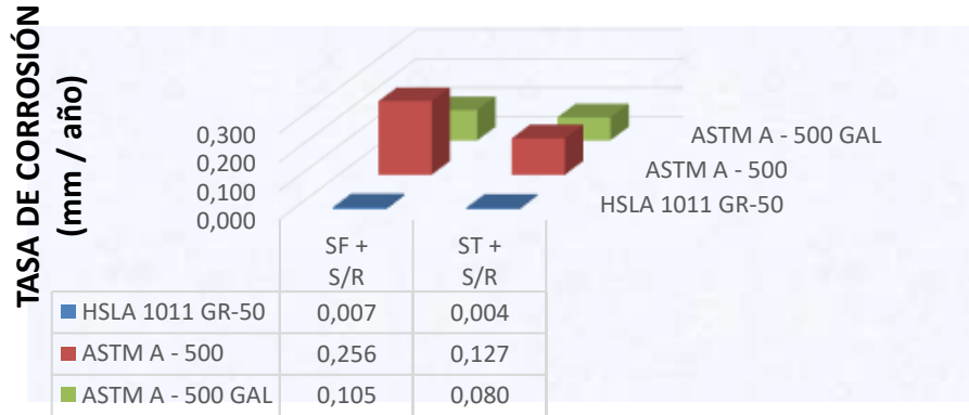
Fig 4.46: Tasa de corrosión de los materiales HSLA – ASTM A – 500 y Galvanizado sin ningún tipo de recubrimiento con juntas a filete y tope, para 280 horas.
