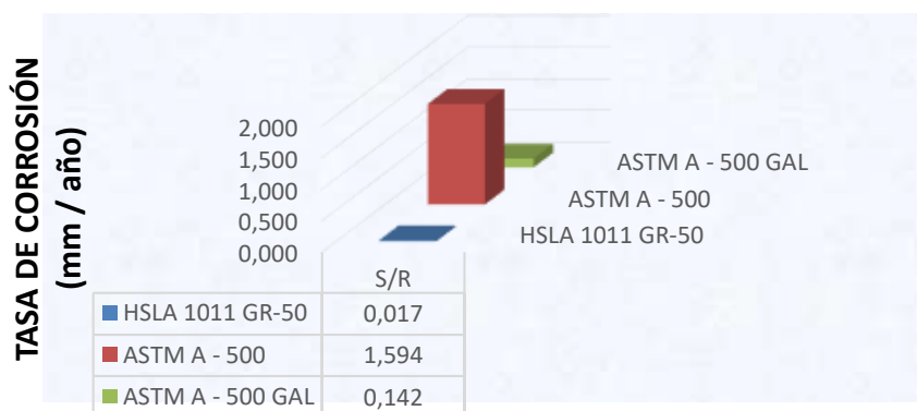
Fig 4.24: Tasa de corrosión de los materiales HSLA – ASTM A – 500 y Galvanizado sin ningún tipo de recubrimiento (380 horas).
