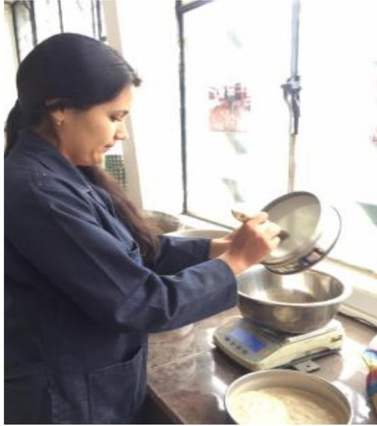
**Descripción:** Peso del suelo retenido en los tamices. Ensayo de granulometría
