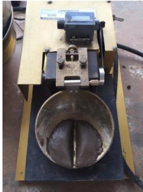
**Descripción:** Rajadura a la muestra de suelo para el ensayo de límite líquido.
