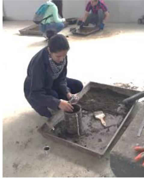
**Descripción:** Toma de muestras para obtener el contenido de humedad del Próctor.
