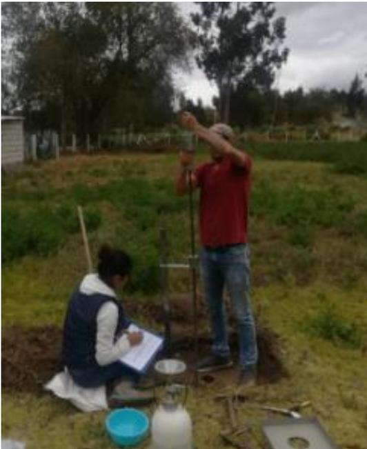
**Descripción:** Realización del ensayo DCP.
