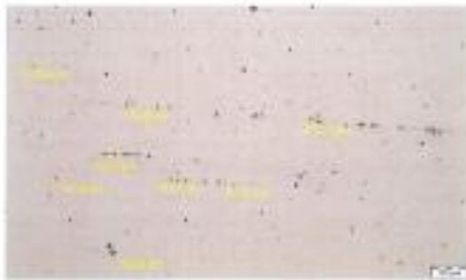
Fotografía N° 7. Sección de tubería con espesor de 5 mm, sentido longitudinal con presencia de inclusiones no metálicas de 14,10 \mu\text{m} (micras), en sentido del conformado mecánico del elemento.
