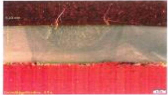
Fotografía N° 4. Sección de tubería espesor de 7 mm con soldadura, fusión completa entre pases, libre de fisuras, escoria y poros.
