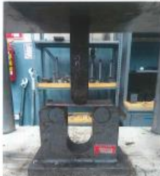
Fotografía 2. Montaje de probeta de doblado en la máquina universal de ensayos.
