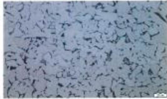
Fotografía N° 18. Sección de tubería con espesor de 10 mm, sentido longitudinal, matriz correspondiente a una de tipo ferrítica con colonias de perlita.
