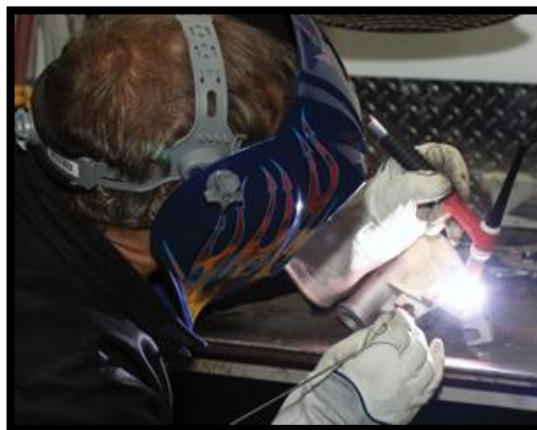
Figura 7. Proceso de soldadura GTAW [40].
