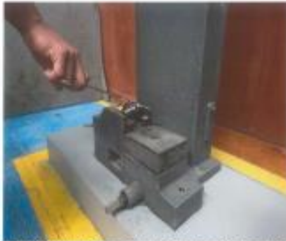
Fotografía 3. Montaje de probeta en la máquina de impacto charpy.
