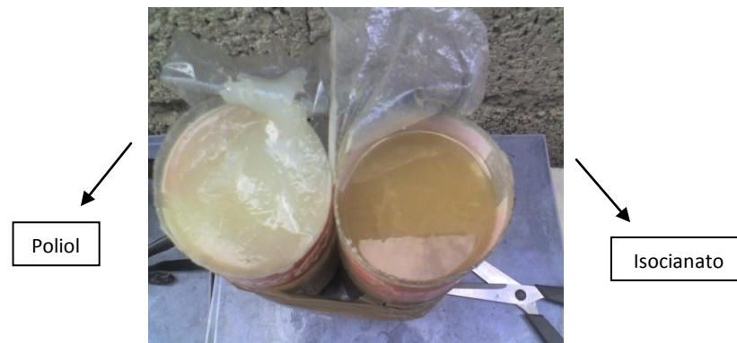
Fig. 4.5. Componentes del poliuretano antes de ser calentados
