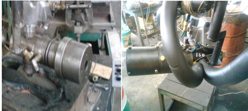
Fig. 2.5. Cabezal de inyección
