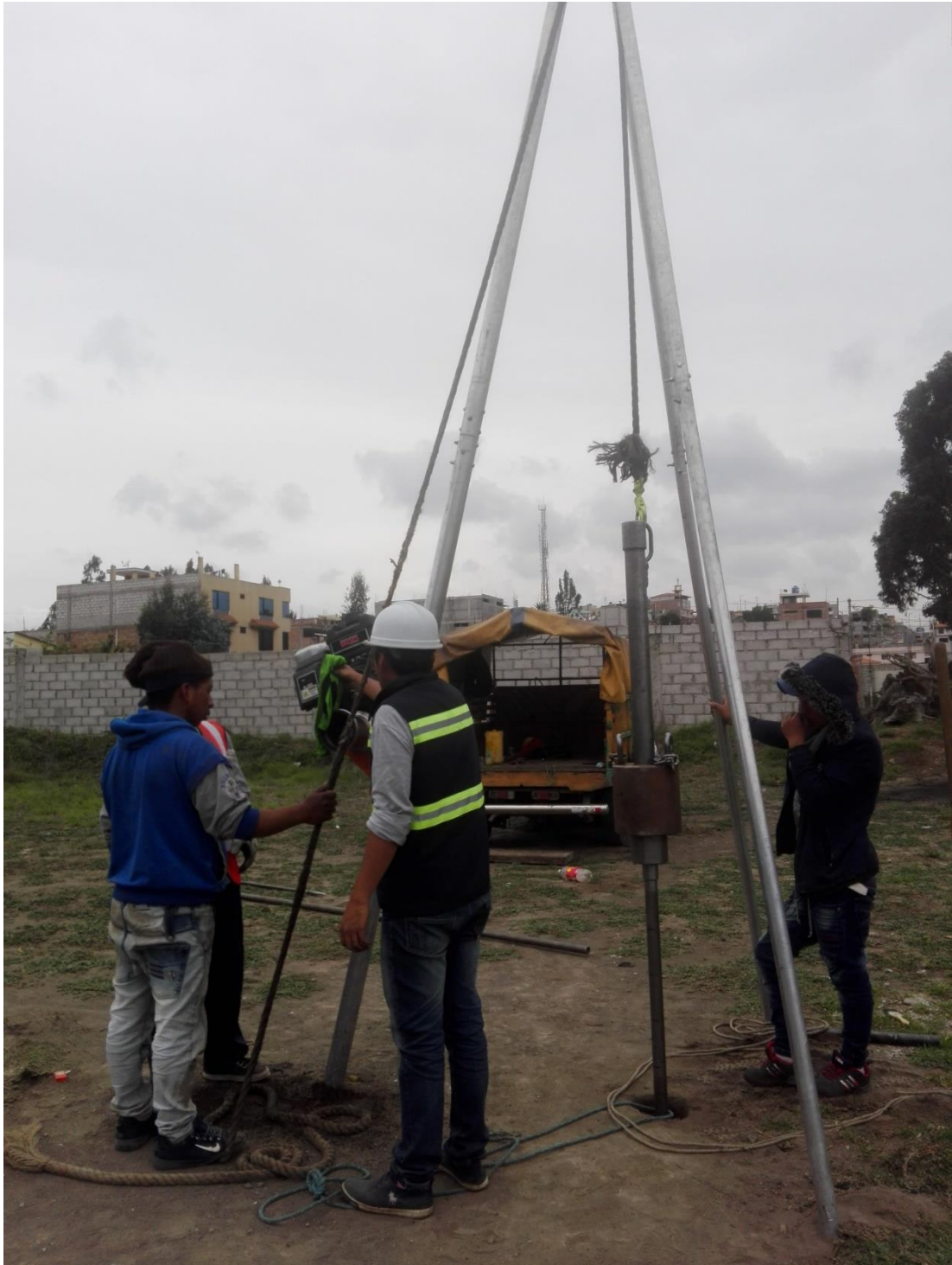
Fotografía 2: Realizando el Ensayo de penetración estándar (SPT).
