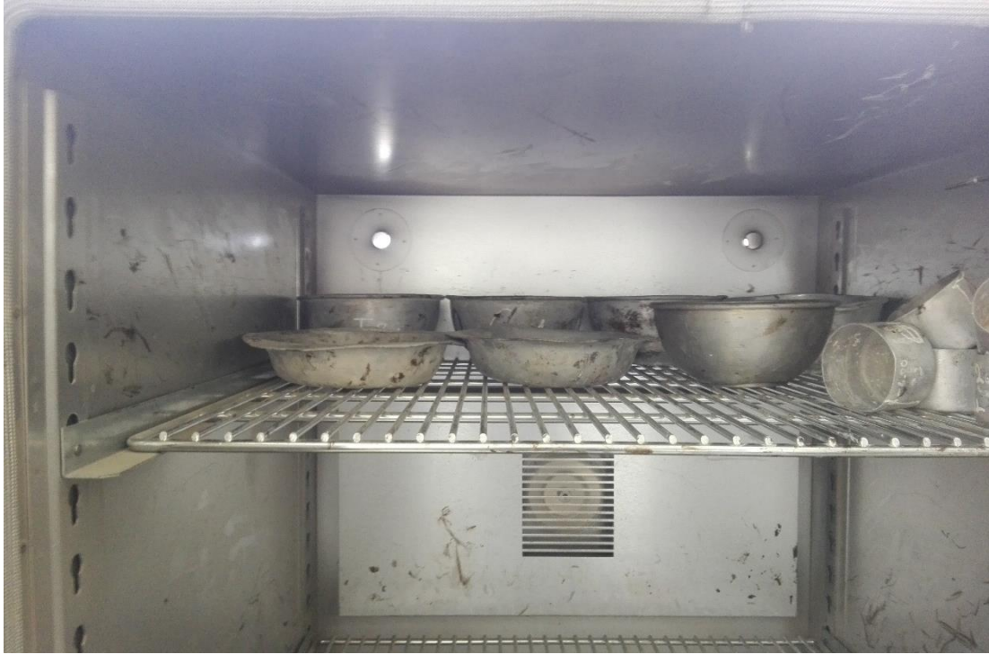
Fotografía 5: Muestras de suelo en el horno para secado (Laboratorios FICM).
