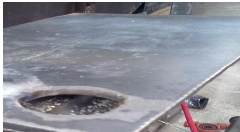
Figura 78. Perforaciones en placa metálica
