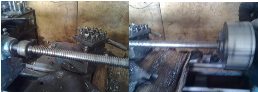
Figura 76.Torneado del sin fin.
