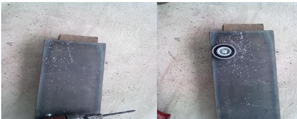
Figura 69. Perforaciones para sujetar los rodamientos.
