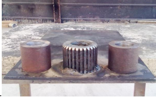
Figura 80. Colocación de las guías en placa
