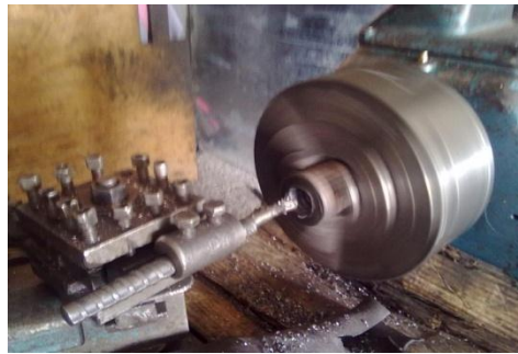
Figura 77. Torneado de la tuerca del sin fin.
