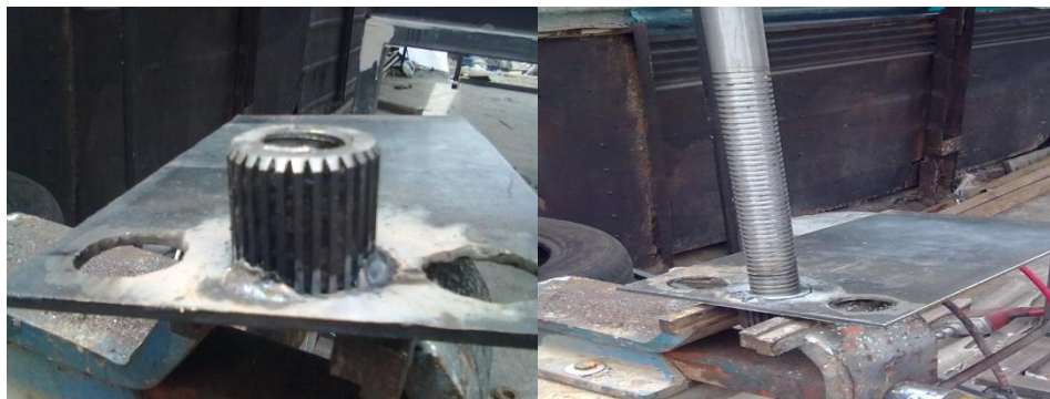
Figura 79. Colocación de la tuerca en placa metálica
