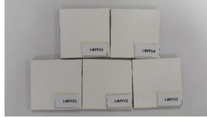
Figura 4.3 Probetas para ensayo a impacto fibra de vidrio.
