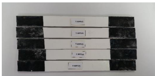
Figura 4.1 Probetas para ensayo a tracción con cinta de lija y fibra de vidrio.
