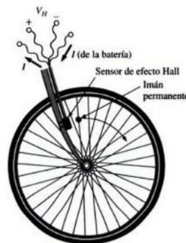
Figura 10. Determinación de la velocidad de una bicicleta por efecto Hall. [21]
