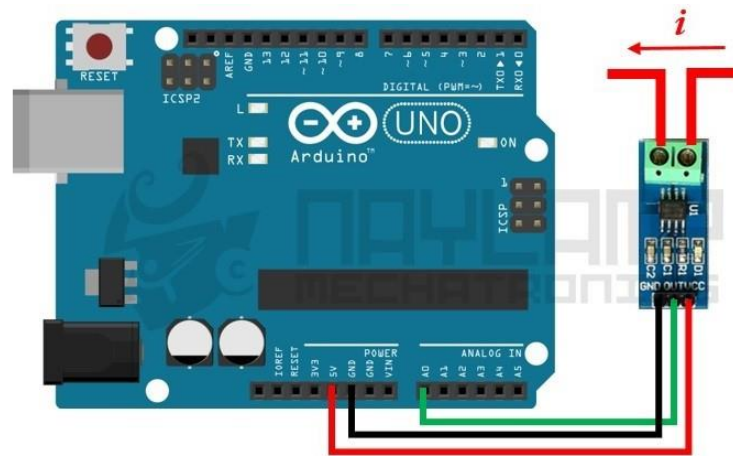
Figura 25. Esquema de conexión sensor CS712.[33]
