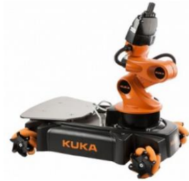
Figura 5. Características del robot móvil KUKA YouBot con brazo. [19]
