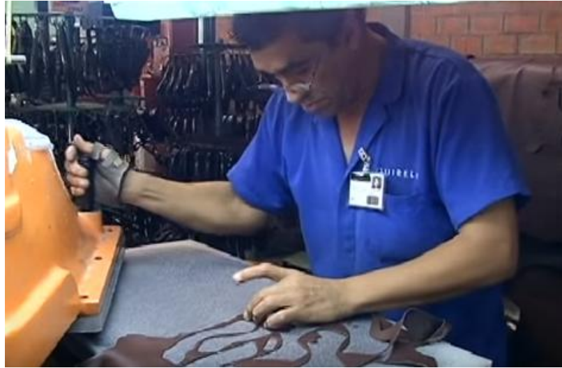
Figura 22 -Troquelar contrafuertes y punteras.
