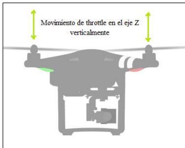
**Fig. 16:** Movimiento de throttle en el eje Z verticalmente. [38]
