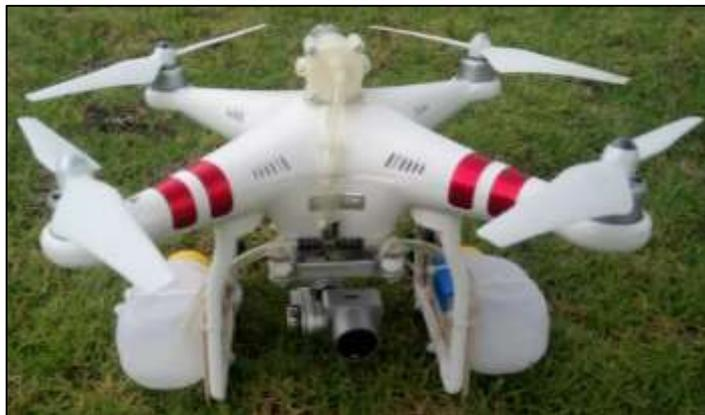
**Fig. 24:** Sistema de pulverización acoplado en el vehículo aéreo no tripulado.
