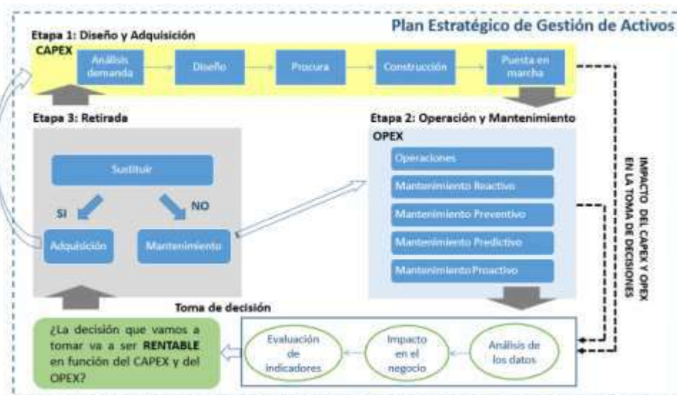
Ilustración 9. Plan estratégico de Gestión de Activos para la toma de decisiones Fuente: Amendola (2016)
