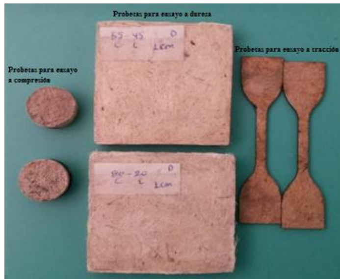
Figura 4-34 a) Probetas en forma Circular para ensayo a compresión, b) Probetas en forma cuadradas para ensayo de dureza, c) Probetas en forma halterio para ensayo a tracción.
