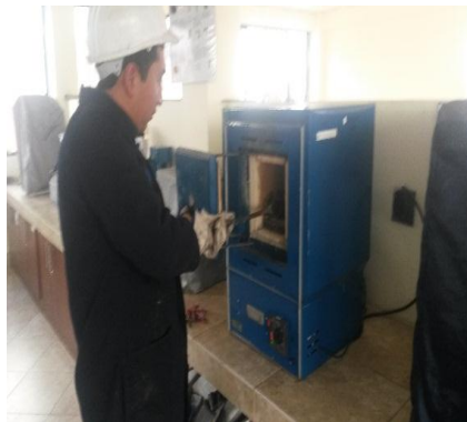
Figura 4-31 Vulcanización del material compuesto Fuente: Autor
