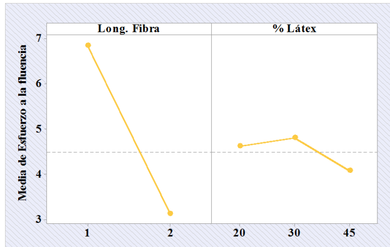
Figura 4-42 Gráfica de efectos principales del esfuerzo a la fluencia. Fuente: Minitab® 18 Statistical Software
