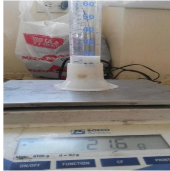
Figura 4-2 Determinación de la densidad del látex sintético.
