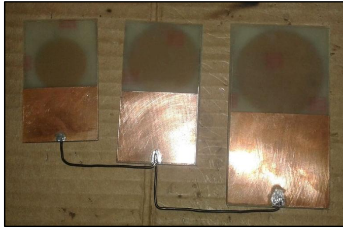
Figura 4.33: Parte posterior de las antenas conectadas en serie Elaborado por: Investigador
