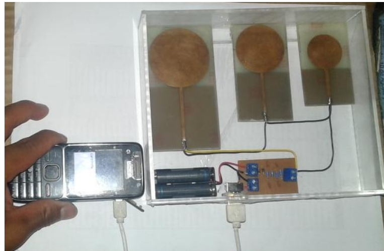
Figura 4.48: Sistema completo recargando un dispositivo móvil Elaborado por: Investigador
