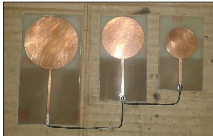
Figura 4.32: Parte frontal de las antenas conectadas en serie Elaborado por: Investigador
