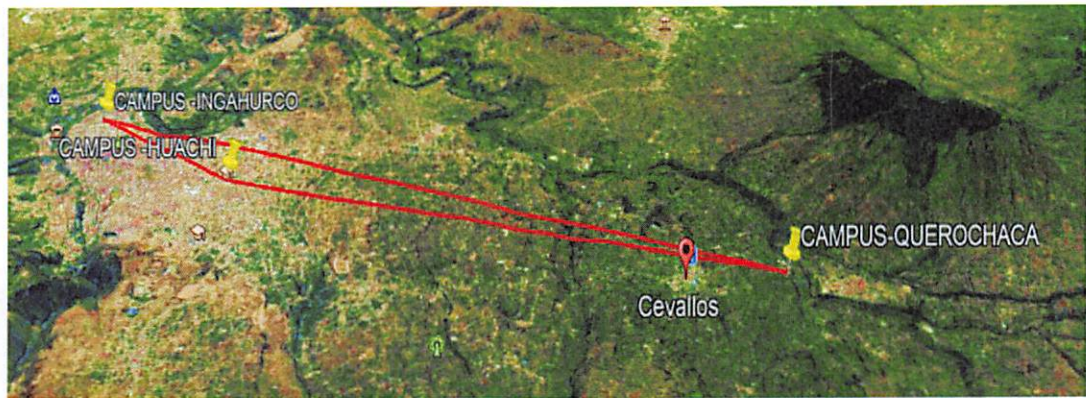
Figura 4. 58.- Diseño de enlace entre los 3 campus de la Universidad Técnica de Ambato
