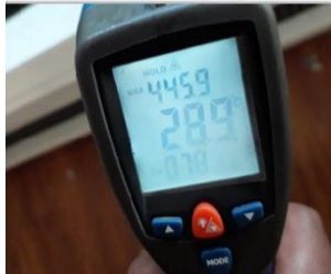
Figura 2-28. Medición de la temperatura superficial de la placa
