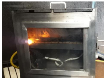
Figura 2-34. Esperar que llegue el pie de llama a la primera marca
