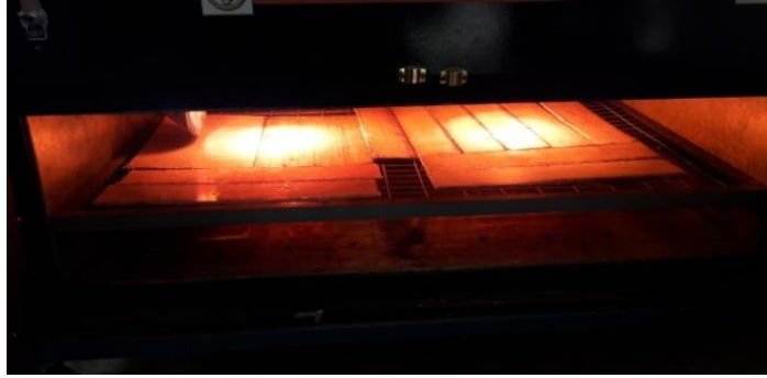
Figura 2-11. Ingreso de las probetas al secador infrarrojo.
