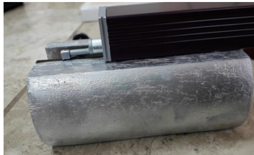
Figura 2-26. Ubicación de la probeta y el rugosímetro
