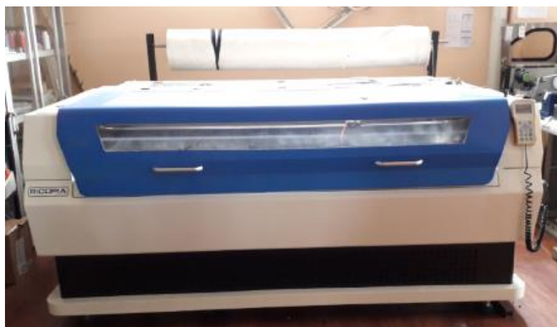
Figura 2-1. Cortadora láser RICOPIA
