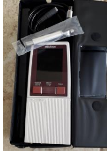
Figura 2-22. Rugosímetro MITUTOYO SJ 210
