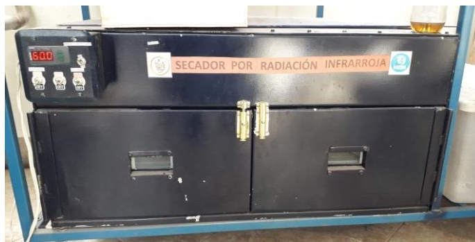
Figura 2-12. Curado de las probetas a una temperatura de 60°C
