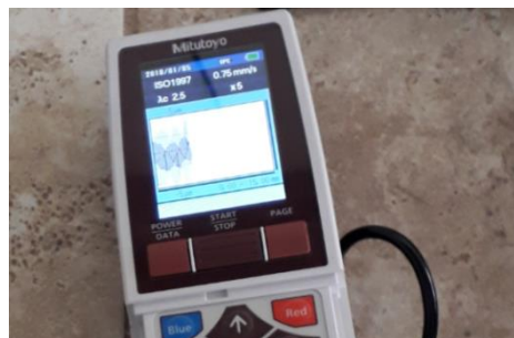
Figura 2-27. Medición de la rugosidad
