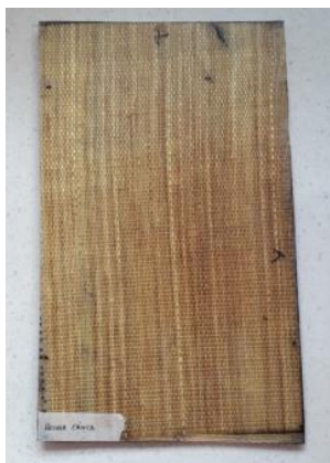
Figura 2-14. Compuesto desmontado (RE + FA)
