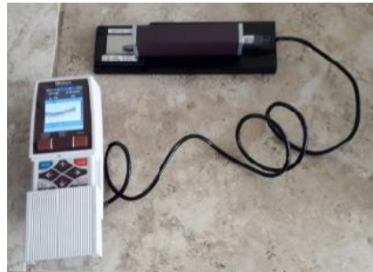
Figura 2-23. Ensamble del Rugosímetro MITUTOYO SJ 210
