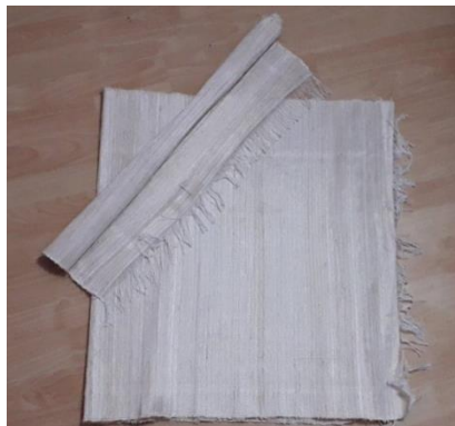
Figura 2-8. Tejido plano entre la fibra de algodón y fibra de abacá
