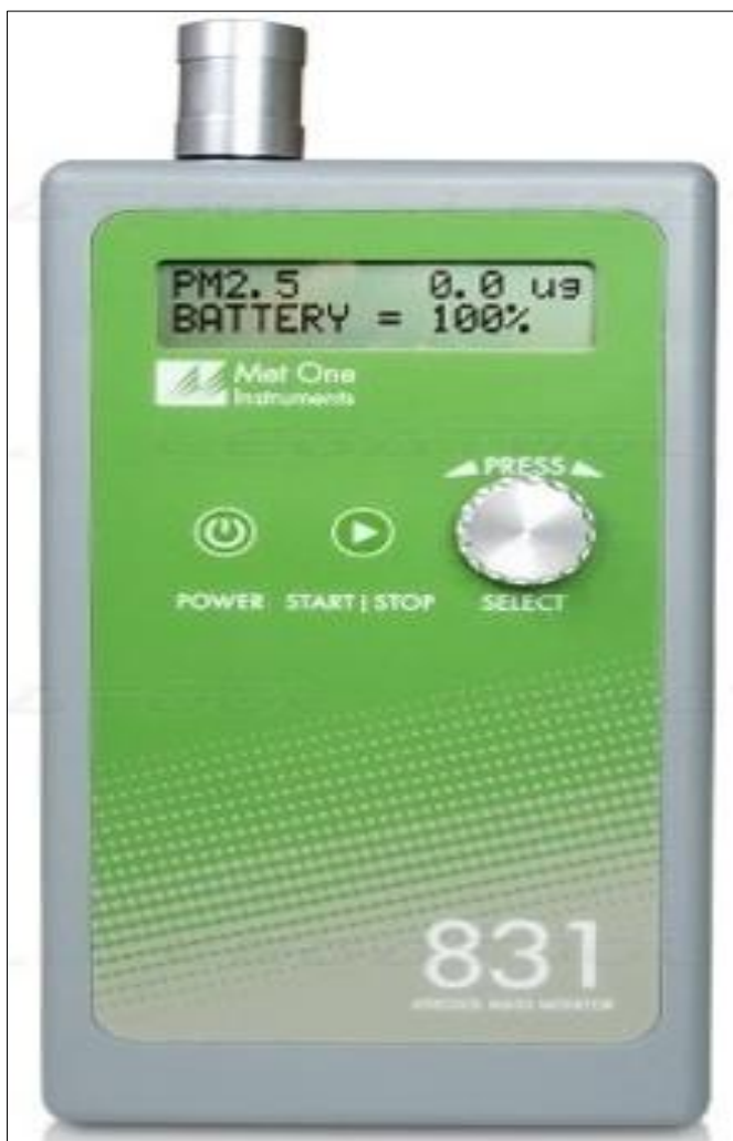
Gráfico N° 30. Medidor de material particulado Fuente: MET ONE Aerocet 831
