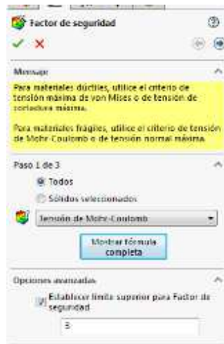
Figura 3-14 Factor de seguridad de 3 para el criterio de falla coulomb Mohr. Fuente: Autor
