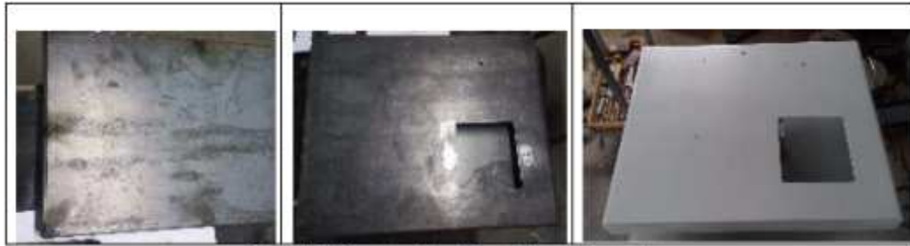
Figura 3-19 Construcción de la caja base. Fuente: Autor
