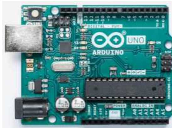
Figura 2-10 Placa Arduino Fuente: [19]
