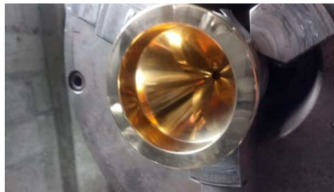
Figura 4-6 Proceso de pulido del embudo de Hall. Fuente: Autor
