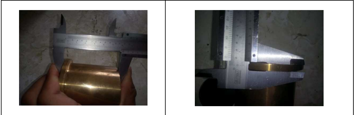
Figura 4-3 Medición de longitudes. Fuente: Autor.
