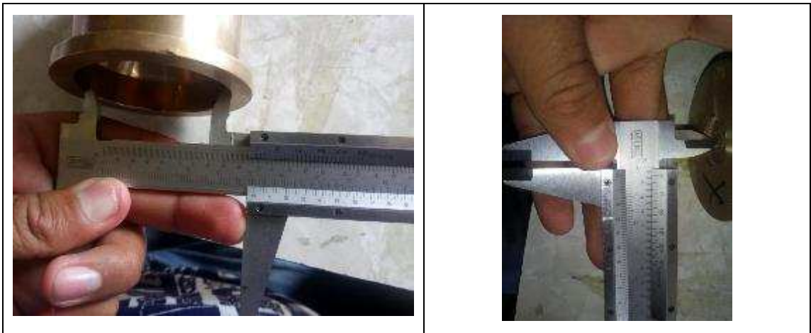
Figura 4-2 Mediciones de diámetros interiores. Fuente: Autor
