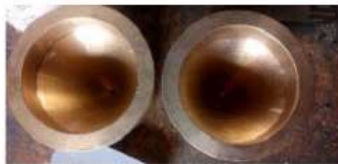
Figura 3-22 Fabricación de embudos de Hall. Fuente: Autor
