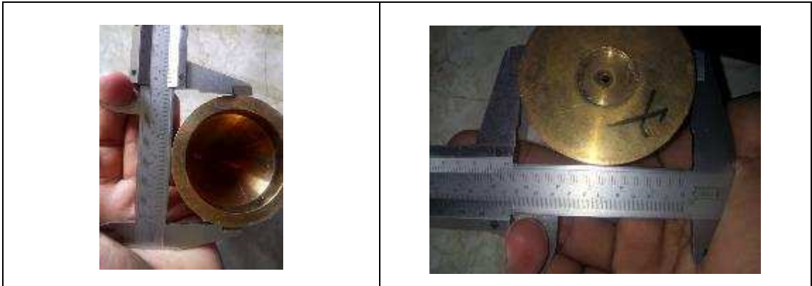
Figura 4-1 Mediciones de diámetros exteriores. Fuente: Autor
