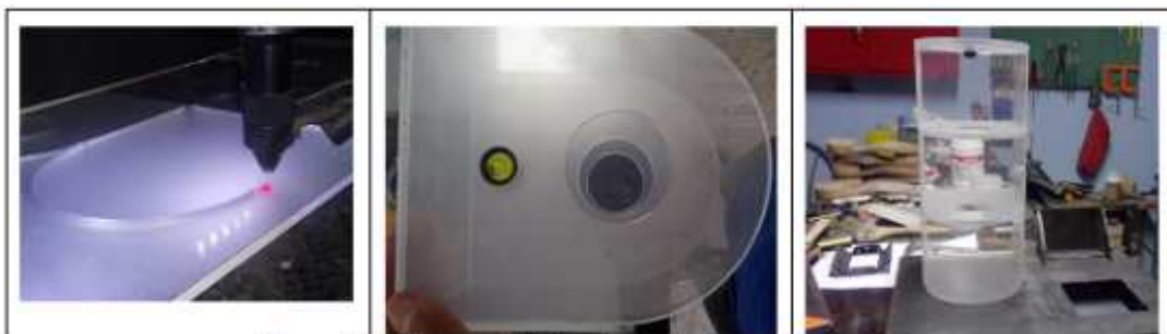
Figura 3-20 Fabricación de la cabina cubreflujos. Fuente: Autor.
