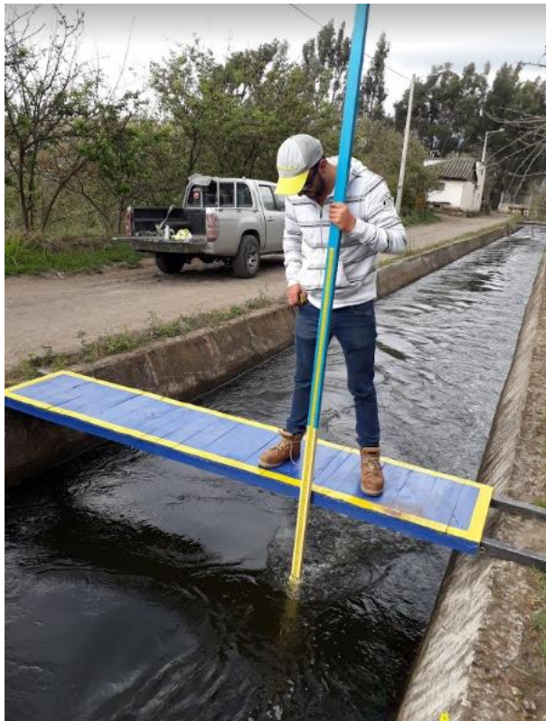
4. Regla graduada para medir el calado y altura del canal
