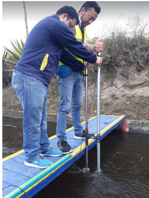
Figura 21. Medición de velocidades
