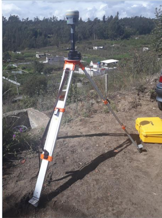
3. Toma de puntos de control con gps diferencial
