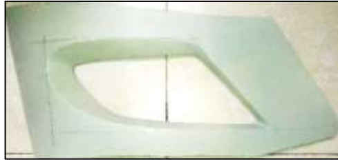
Figura 51. Cerco de faro fabricada con el mejor grupo de material compuesto.
