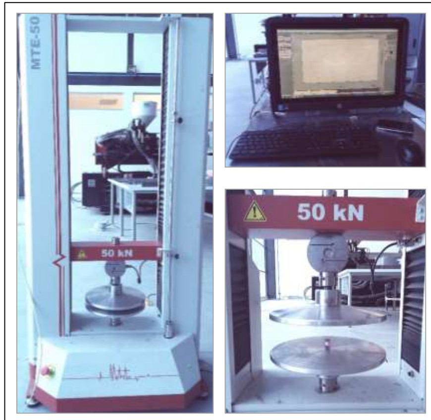
Figura 30. Ensayo a compresión.
