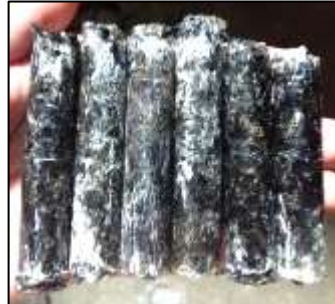
Figura 26. Obtención de cilindros de material compuesto para probetas a compresión.
