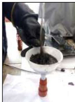
Figura 25. Fabricación de probetas a compresión.
