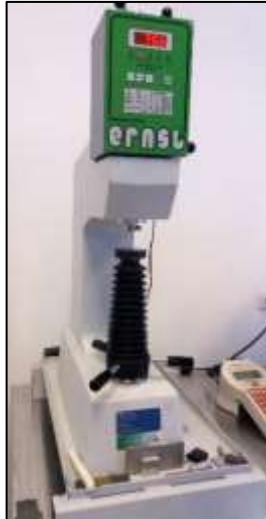
Figura 32. Durómetro Universal ERNST modelo NR3 DR.
