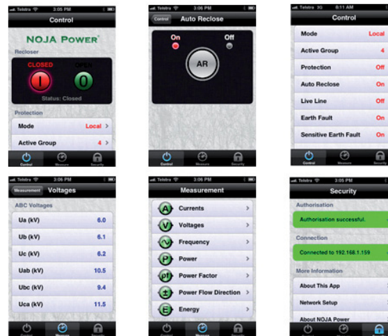
PANTALLAS DE LA APLICACIÓN REMOTA DEL RECONECTOR NOJA POWER
