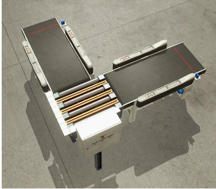
Figura 12. Módulo para el pulido de los bordes de las piezas de vidrio.
