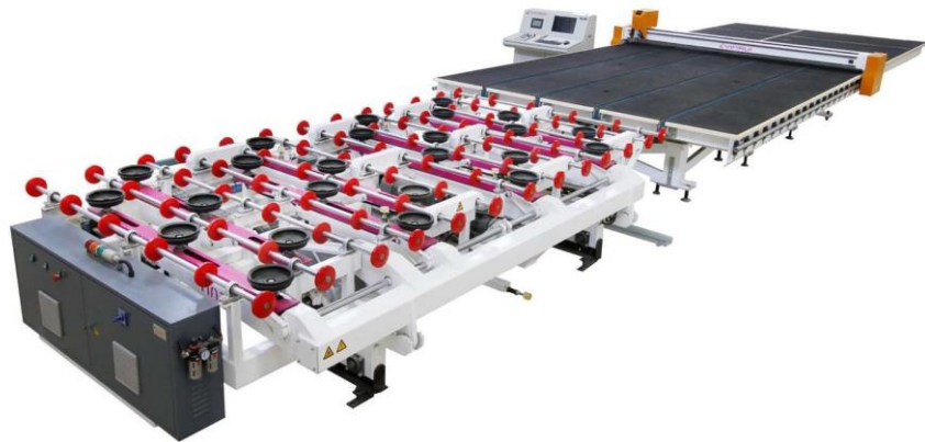
Figura 9. Mesa automática de corte [23].
