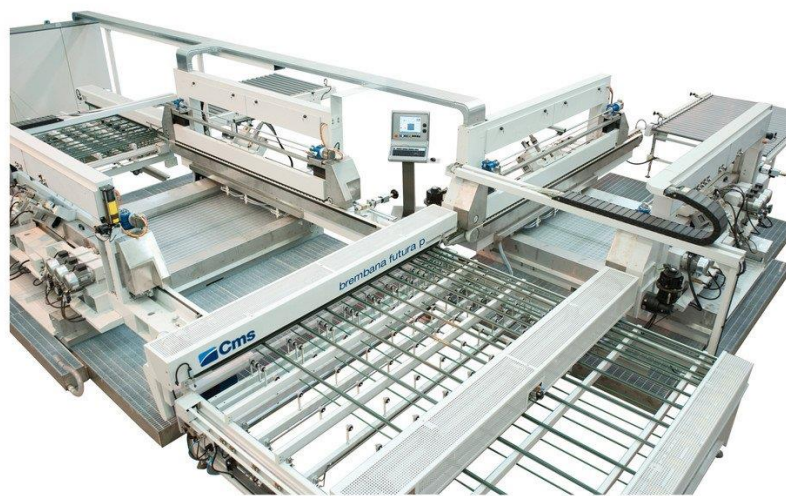
Figura 11. Rectificadora de vidrio CMS BREMBANA FUTURE P [23].
