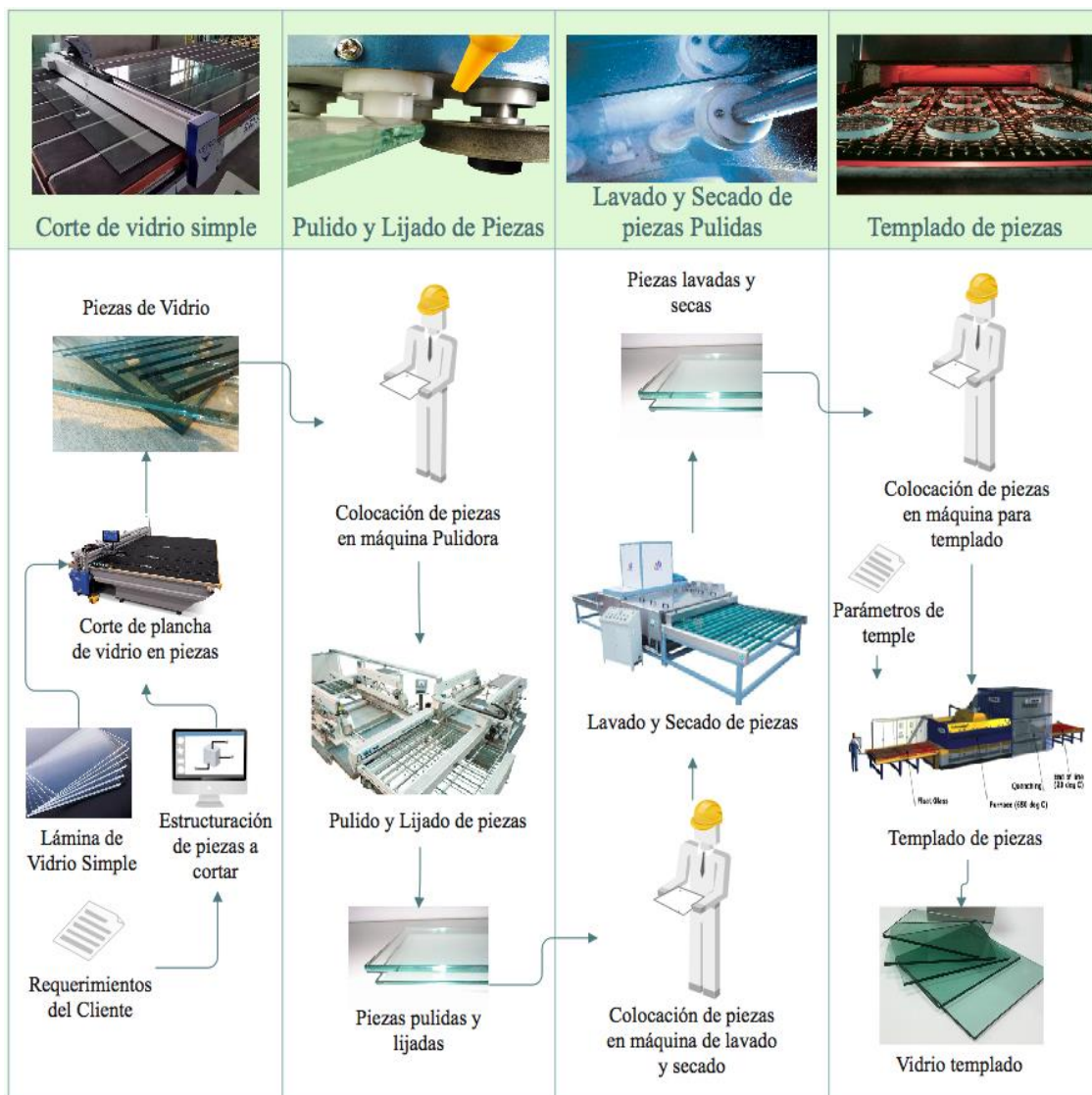
Figura 8. Proceso de producción de vidrio templado.
