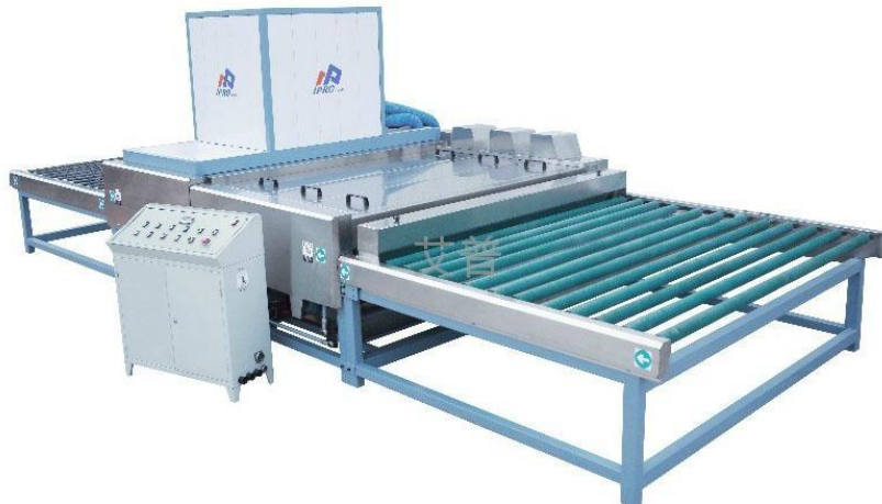
Figura 13. Máquina de lavado y secado de vidrio [24].
