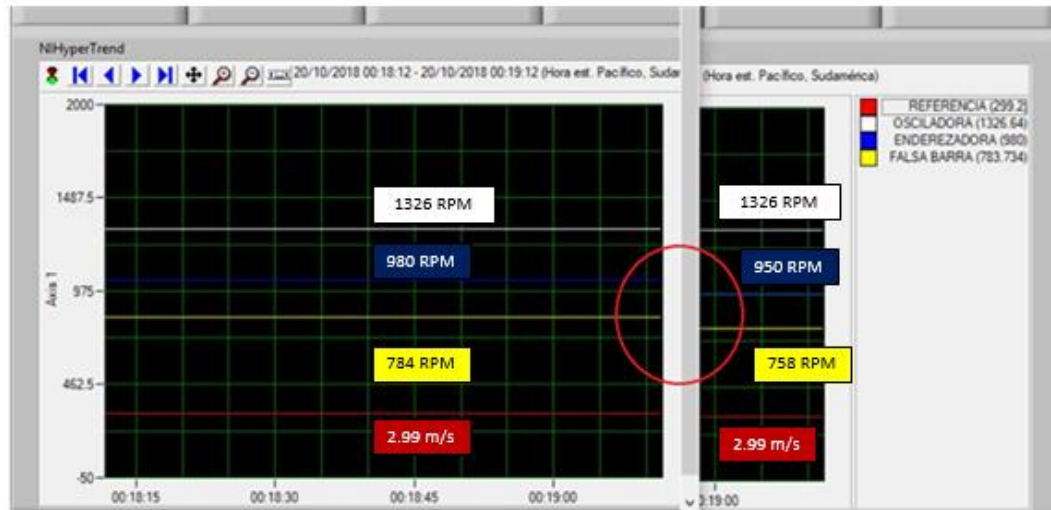
Fig. 80 Comparación de sincronización de velocidades anterior vs actual.
