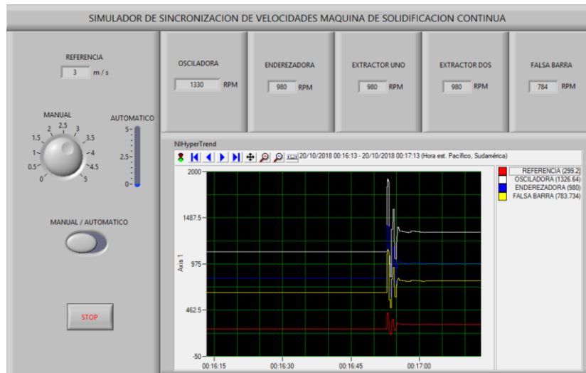
Fig. 78 Pantalla de simulación de sincronización de velocidades actual.
