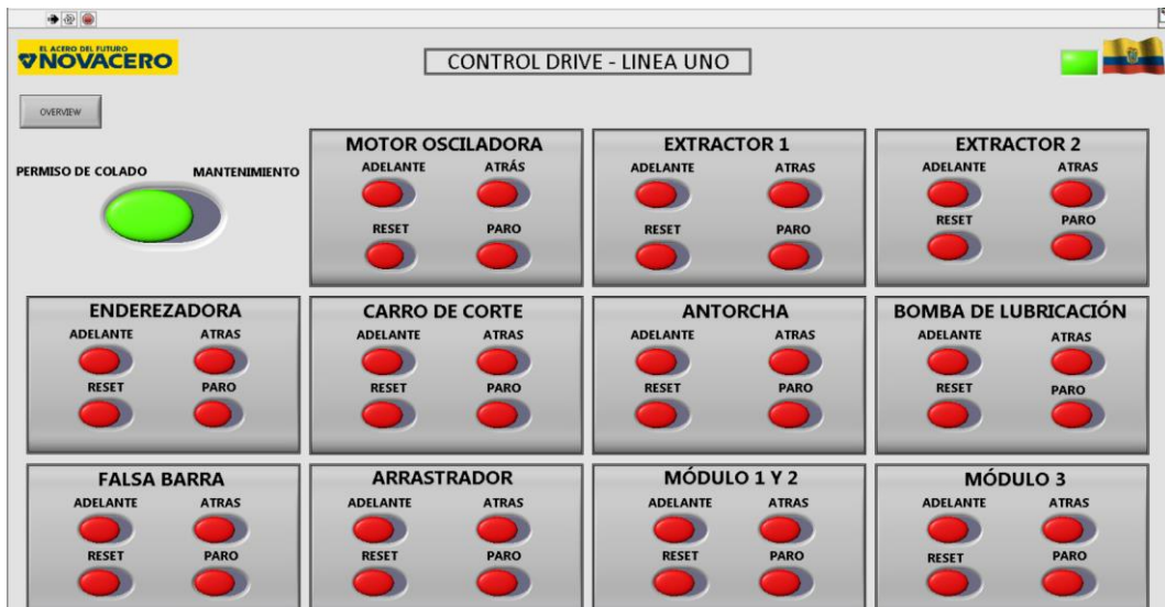
Fig. 102 HMI mantenimiento de VDF's Elaborado por: Trajano Espinosa.
