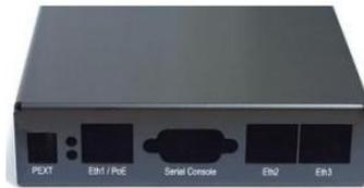
**Figura 6.39.** Caja para el RouterBoard RB433AH
