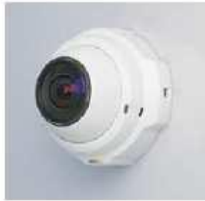
Figura N° 2. 13 Cámara PTZ IP no mecánica.
