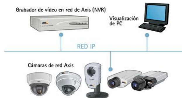
Figura N° 6. 3 Sistema de video-vigilancia en red que utiliza un NVR Fuente: http://www.axis.com/es/products/video/about_networkvideo/platforms.htm
