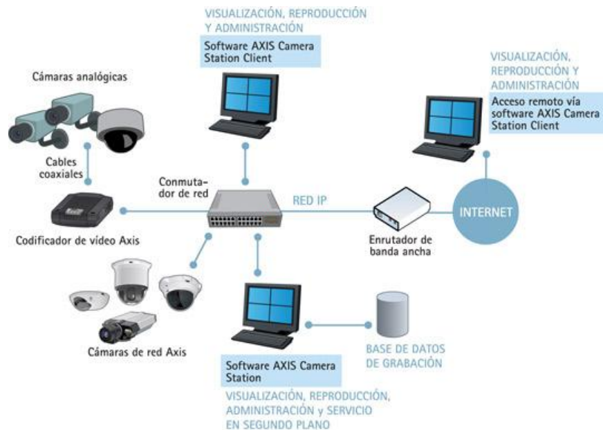
Figura N° 6. 2 Sistema de video-vigilancia en red basado en una plataforma abierta de servidor de PC
