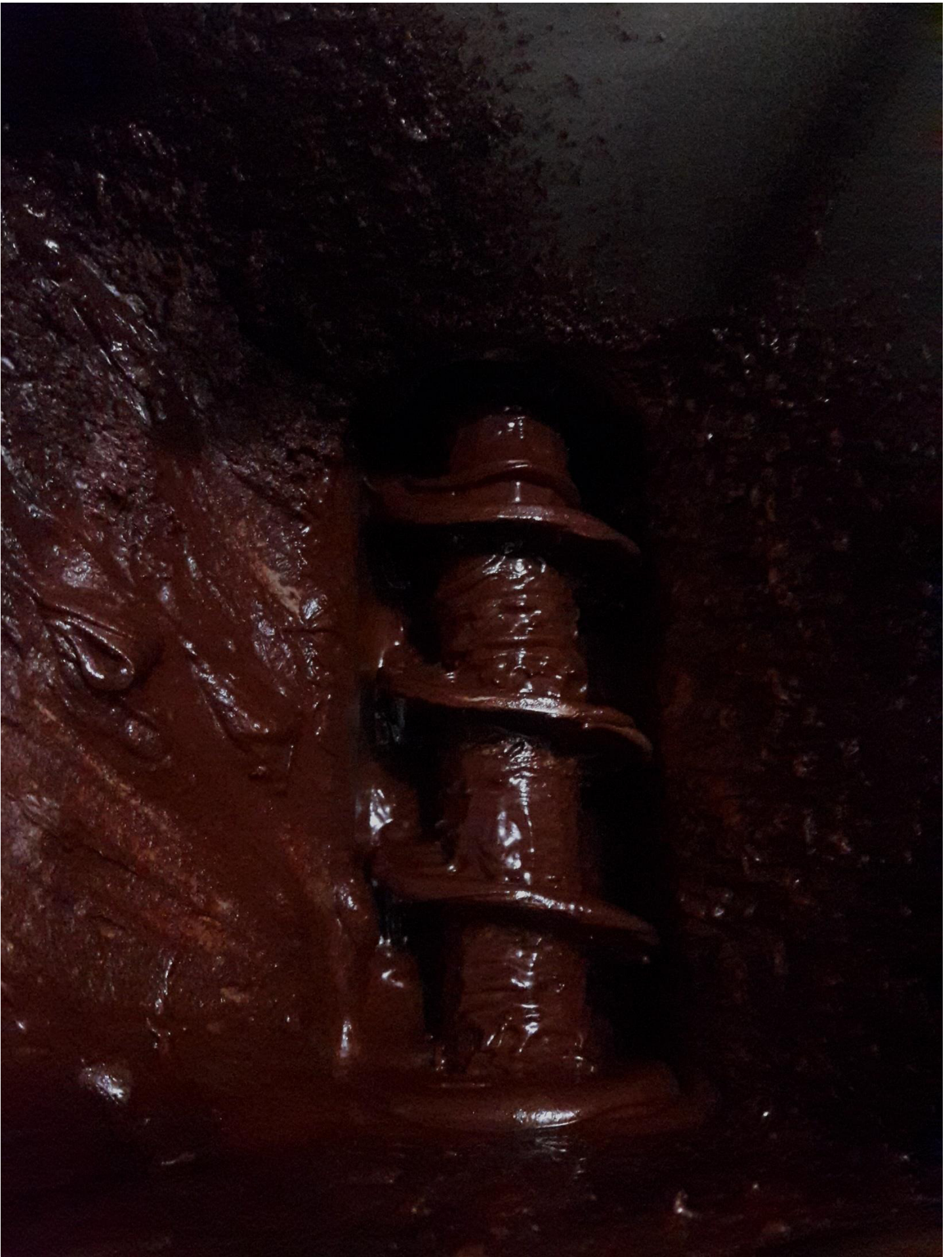
Imagen N° 31: Aspas del molino con chocolate Fuente: La autora
