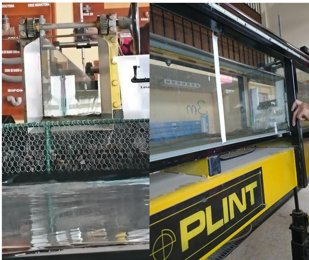
Figura 11. Canal con dissipador de energía en el Laboratorio de la Facultad de Ingeniería Civil y Mecánica.
