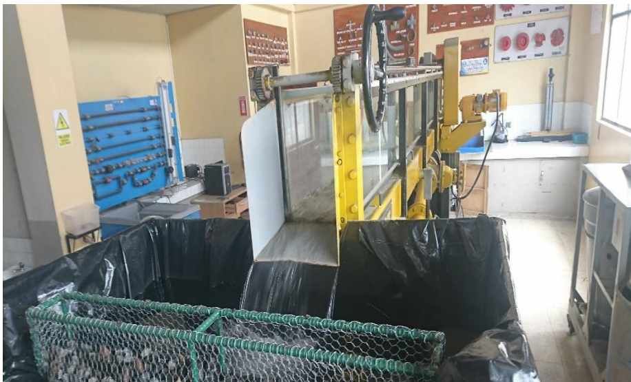
Figura 10. Canal con disipador de energía en el Laboratorio de la Facultad de Ingeniería Civil y Mecánica.
