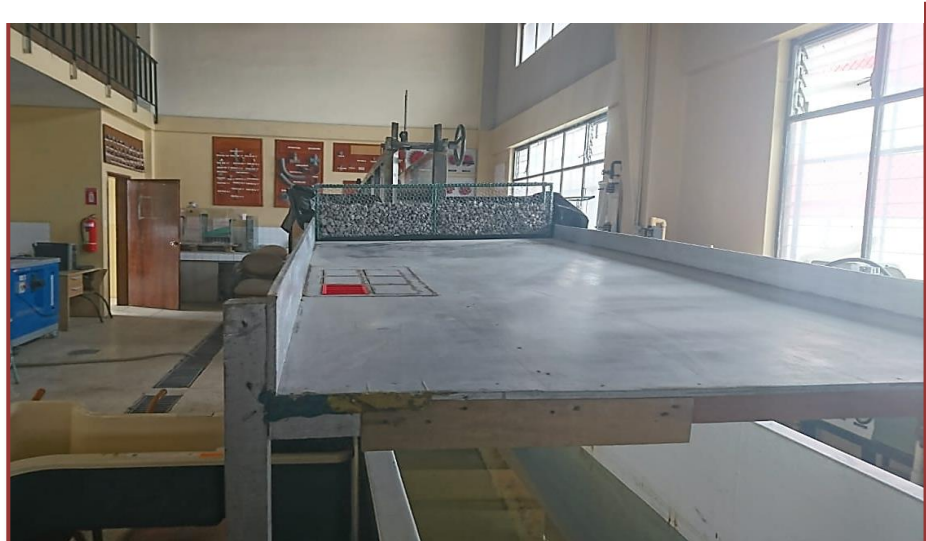
Figura 4. Prototipo de vía a escala 1:4 con escenario 1 en el laboratorio de la facultad de ingeniería civil y mecánica.
