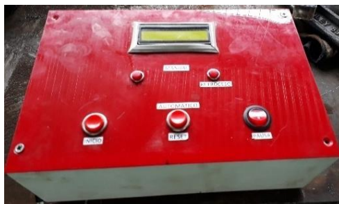
Imagen 24. Cuadro de control de la Maquina de ensayos a fatiga de juntas a corte.
