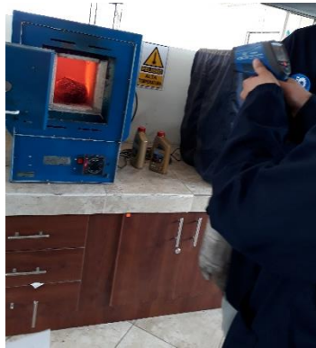
Imagen 32. Verificación de temperatura del temple.
