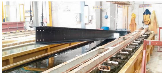
Imagen 3. Elementos extraídos del tanque de decapado ácido.
