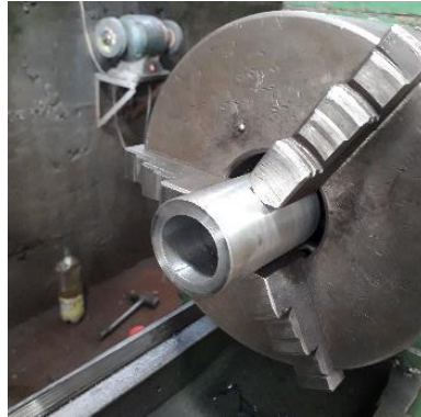
Imagen 27. Torneado de bocines de acero AISI 4340.
