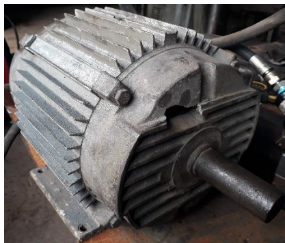
Imagen 21. Motor Trifásico de 7,5 HP de potencia.
