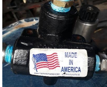
Imagen 22. Válvula reguladora de presión.
