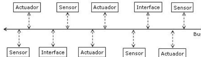
Figura 2.4: Arquitectura domótica distribuida Fuente: http://www.casadomo.com/noticiasDetalle.aspx?c=14
