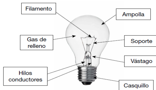
Gráfico N° 9. Partes de una bombilla incandescente Fuente: (INSHT, 2015)
