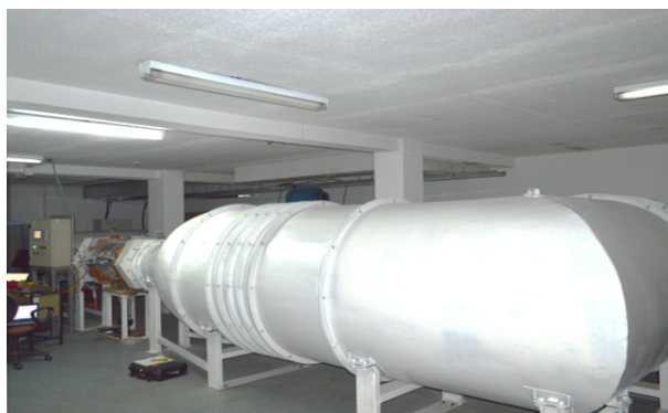
Figura 3.12: Túnel de viento cerrado del INAMHI
