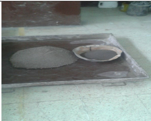
Fotografía 15. Mezcla de materiales para realizar un hormigón con escoria siderúrgica.
