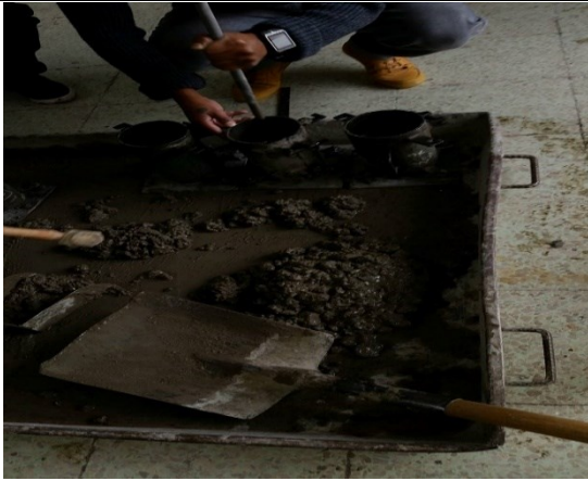
Fotografía 17. Llenado de moldes metálicos
