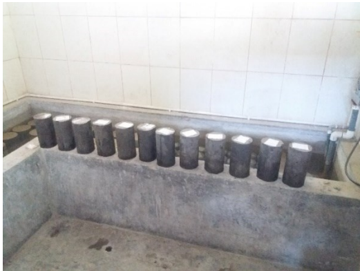
Fotografía 19. Desencofrado de especímenes y colocación en la cámara de curado.
