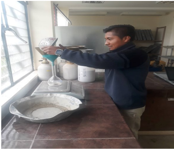
Fotografía 5. Determinación de la densidad real de la arena.
