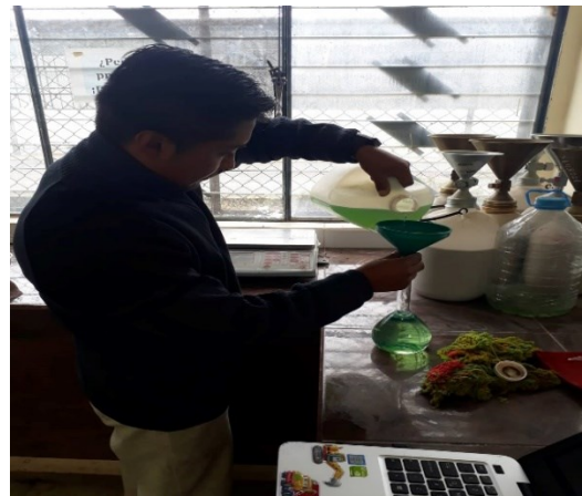
Fotografía 8. Determinación de la densidad real de la arena.
