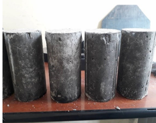
Fotografía 22. Tipo de rotura a especímenes
