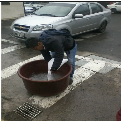
Fotografía 25. Colocación de 5600gr en agua (80gr/lit).
