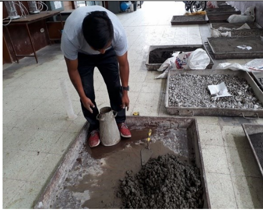
Fotografía 13. Determinación del asentamiento con el cono Abrams
