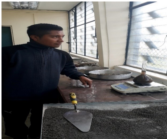
Fotografía 7. Determinación de la densidad real de la escoria
