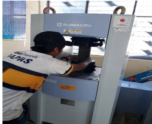
Fotografía 20. Ensayo de compresión a especímenes a sus edades respectivas
