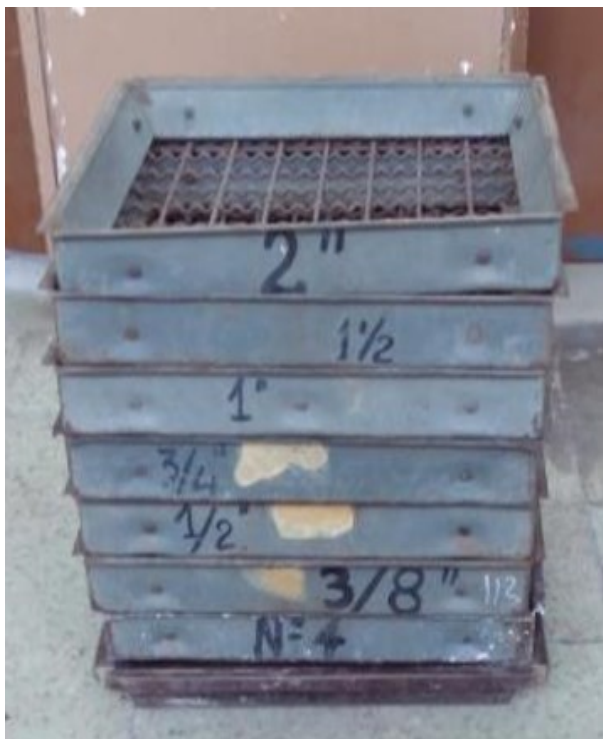
Fotografía 1. Granulometría del agregado grueso
