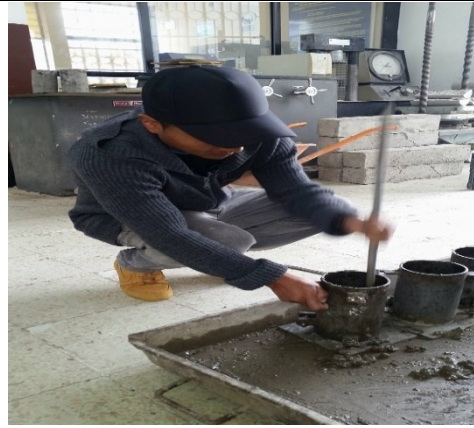
Fotografía 18. Compactación al llenado de muestras.
