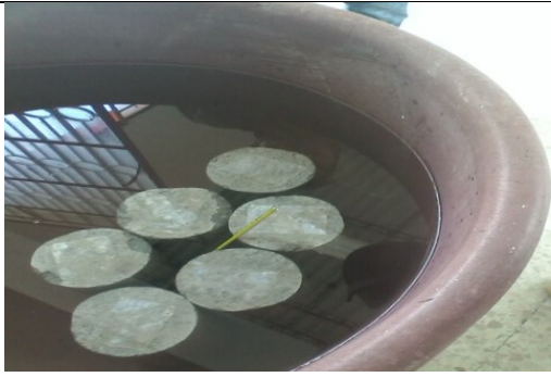
Fotografía 27. Colocación de las primeras muestras en la solución.
