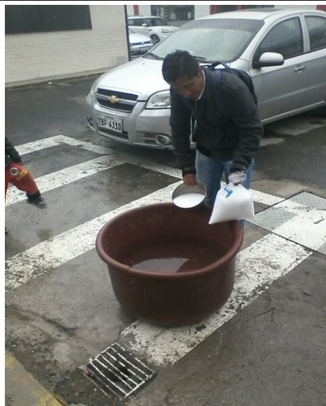
Fotografía 24. Colocación del sulfato de magnesio en 70 lt de agua para el proceso acelerado de sulfatos.
