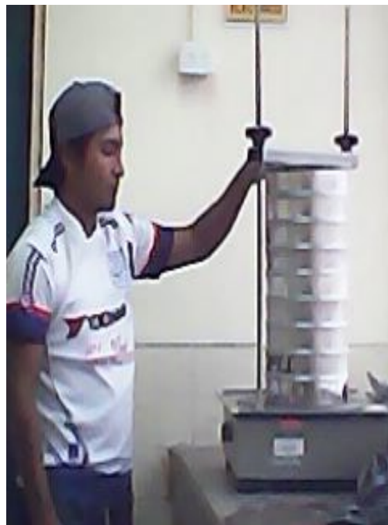
Fotografía 2. Granulometría del agregado fino
