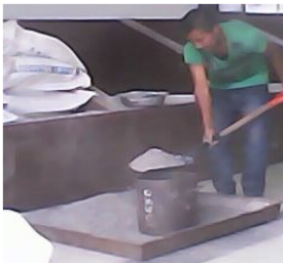
Fotografía 3. Determinación de la densidad aparente suelta
