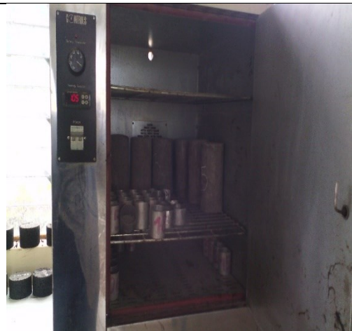
Fotografía 32. Temperatura del horno 105 °C para secar las muestras. Se realiza el mismo proceso para los posteriores ciclos de Inmersión, seca y enfriamiento.
