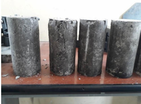
Fotografía 21. Tipo de rotura de los especímenes
