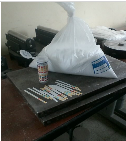
Fotografía 23. Materiales para la preparación de la solución acuosa de sulfato de magnesio MgSO_4 y la determinación del PH de la misma.
