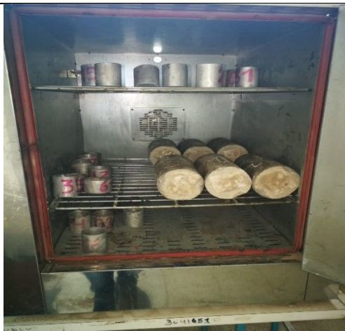
Fotografía 31. Colocación de los especímenes en el Horno después de ser sometidos a la sulfatación para acelerar el proceso de deterioro en las muestras.
