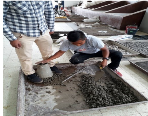
Fotografía 14. Llenado del cono de Abrams
