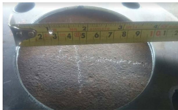
Figura 73: Medición del agujero interior
