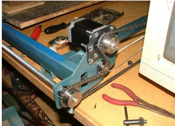
Figura 23: Transmisión de potencia por cadena
