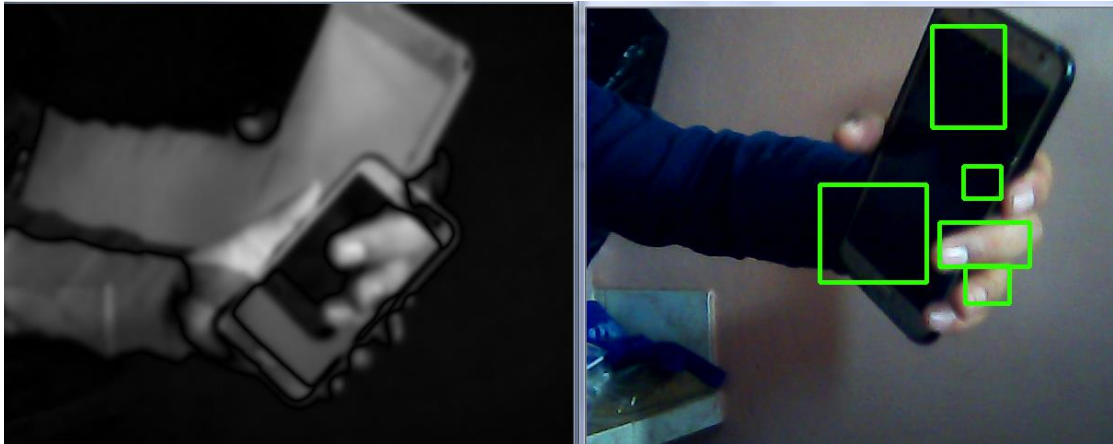
Figura 31. Método supresión de fondo para detectar movimiento Elaborado por: Investigador
