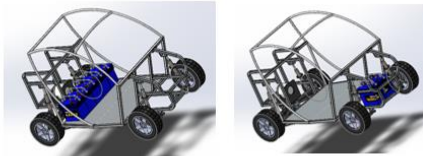
Figura 4. 28 Distribución de los 2 grupos del banco de baterías
