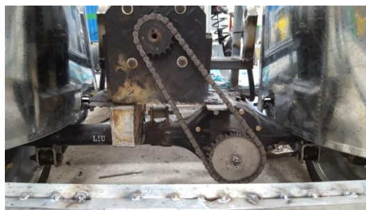
Figura 4. 27 Montaje del motor al sistema de transmisión
