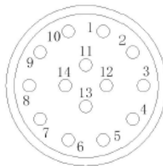
Figura 4. 9 Zócalos correspondientes a los pines J1 y J2. [19]
