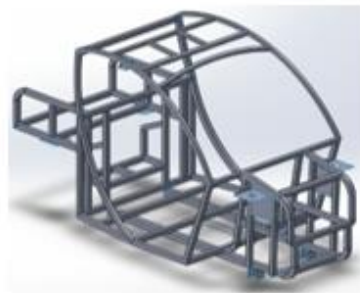
Figura 4. 3 Diseño de la parte posterior del prototipo UTA CIM17
