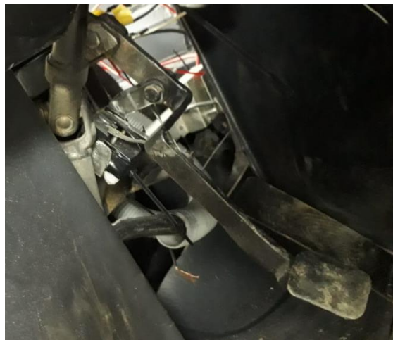
Figura 4. 25 Adaptación del final de carrera al pedal del freno
