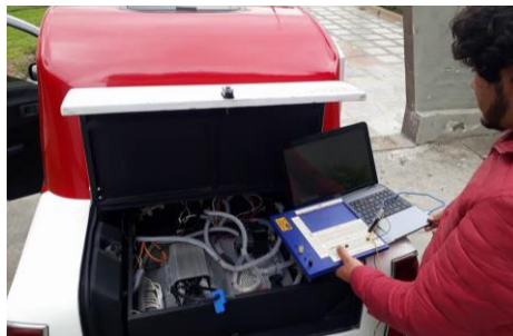
Figura 4. 32 Medición de corriente mediante un sensor de corriente no invasivo
