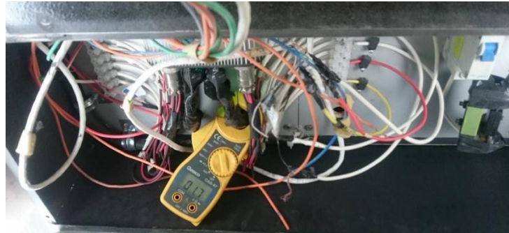
Figura 4. 38 Valor de corriente de salida del controlador al motor con 2 personas a bordo
