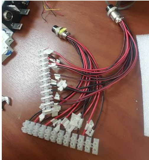
Figura 4. 10 Conexión a los zócalos de los pines J1 y J2
