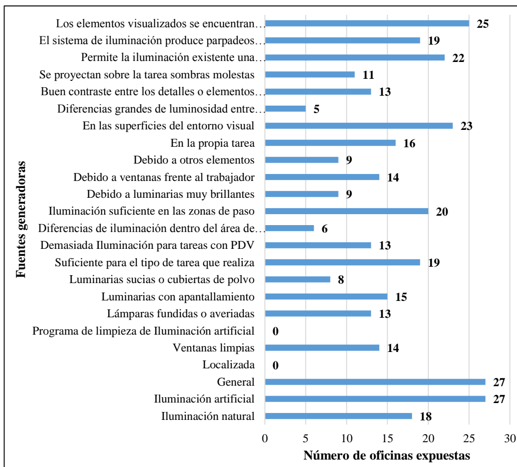
Fig. 13. Resumen de resultados de condiciones de iluminación en puestos de trabajo.
