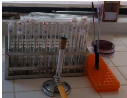
Homogenización de muestras con medio PBS
