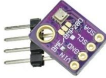
Figura 21. Sensor de presión y temperatura BMP280 [34].
