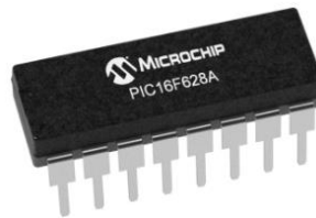
Figura 25. Microprocesador pic 16f628a para el conteo de pulsos [42].
