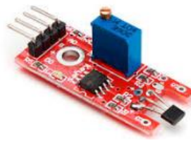
Figura 24. Módulo del sensor de efecto Hall para la medición de la velocidad angular [34].
