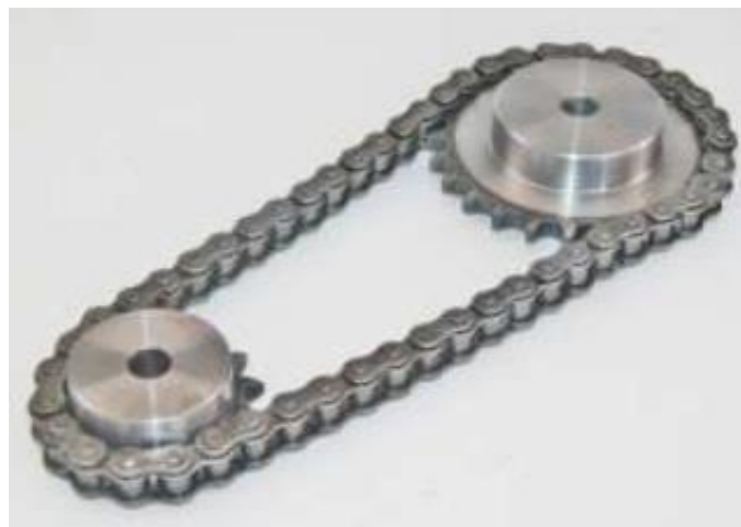
Figura 29: Esquema de la cadena de transmisión [19]
