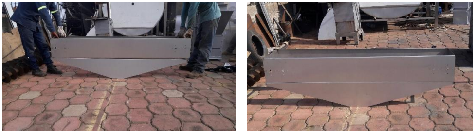
Paredes laterales y tolva
