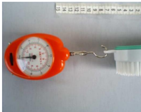
Figura 16: Fuerza de fricción entre la naranjilla y cepillo de fibra de nylon.
