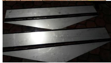
Tolva y paredes laterales
