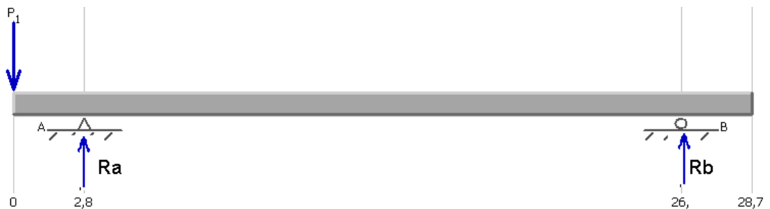
Figura 23: Diagrama de cuerpo libre del eje
